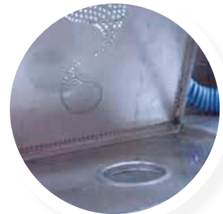
Feinfilter-Einsatz mit guter Zugänglichkeit
